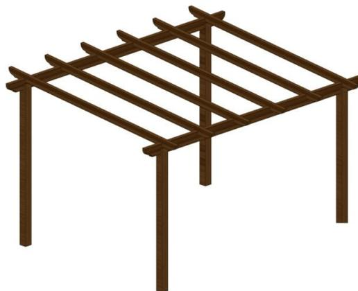
*I profilati impiegati sono costituiti da estrusi in alluminio, il sistema prevede quattro o più colonne a seconda delle dimensioni di impiego e saranno fissate mediante piastre in acciaio. Il pergolato in questo caso sarà **autoportante**, i montanti di falda avranno un interasse variabile in funzione del carico previsto e tutte le tubolarità opportunamente chiuse con tappi brevettati.*
